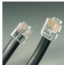
Si vous désirez relier l'interface LI101F aux bornes à visser LMAB d'une centrale LZ100 ou LZV100, coupez le câble vers le milieu et connectez individuellement les conducteurs aux bornes correspondantes de la LZ100 ou LZV100. La disposition de ces conducteurs est indiquée sur la figure ci-contre.
